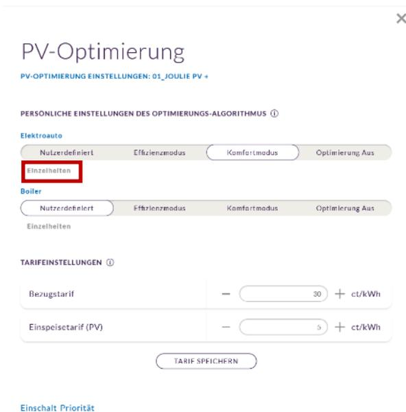
Abbildung 24: Die 4 Grundeinstellungen der PV-Optimierung.
