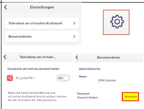
Abbildung 17: Einstellungen im Hauptmenü der App mit Teilnahme am virtuellen Kraftwerk und den Benutzerdaten, die durch den gelb markierten Butten bearbeitet werden können.
