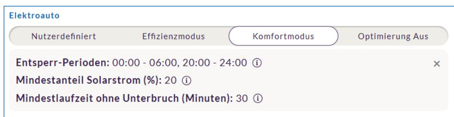
Abbildung 25: Komfortmodus am Beispiel eines Elektroautos.
