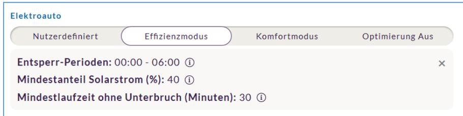
Abbildung 26: Effizienzmodus am Beispiel eines Elektroautos.
