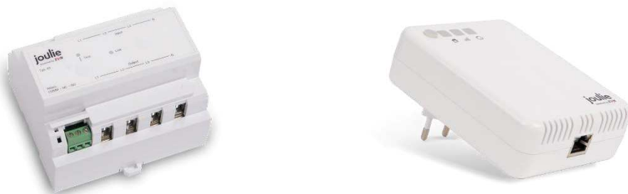
Abbildung 2: K-Box zur Erfassung der Energieströme (links) und M-Box zur Datenkommunikation (rechts)
