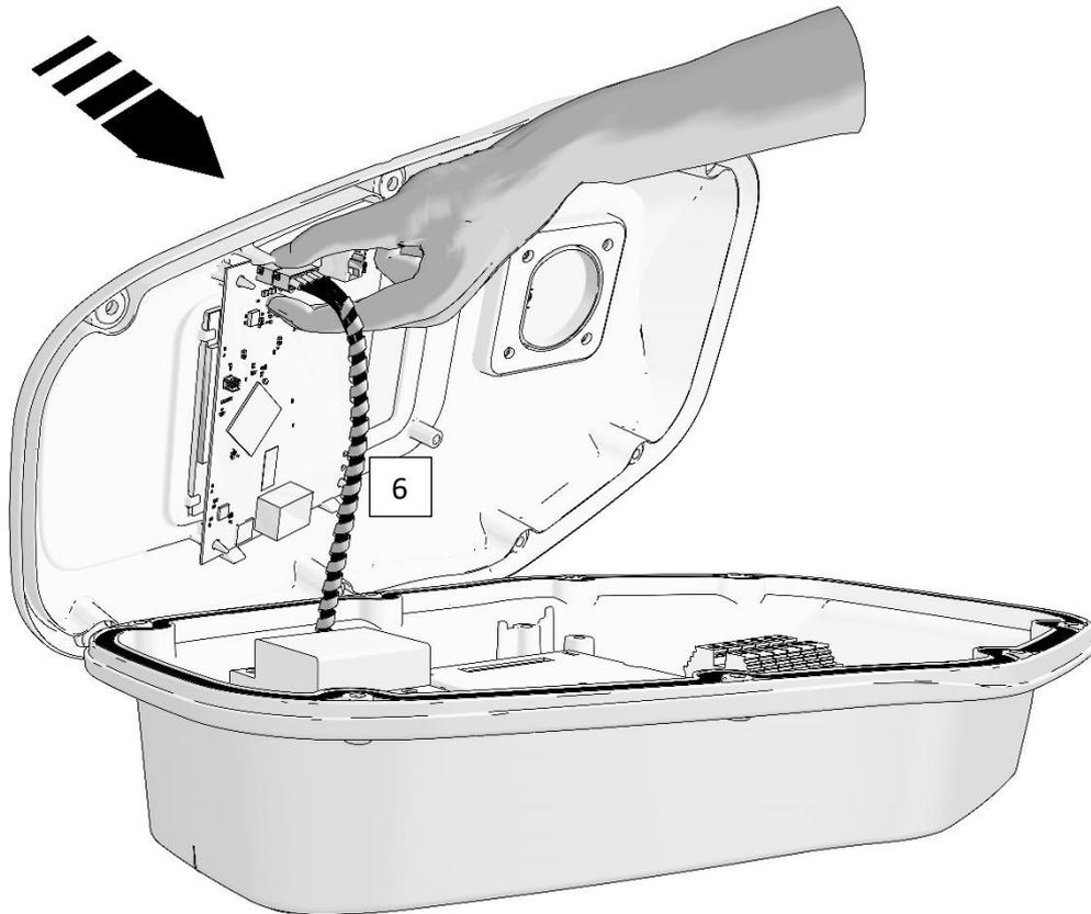
Bild 6 Entfernen des Verbindungskabels
