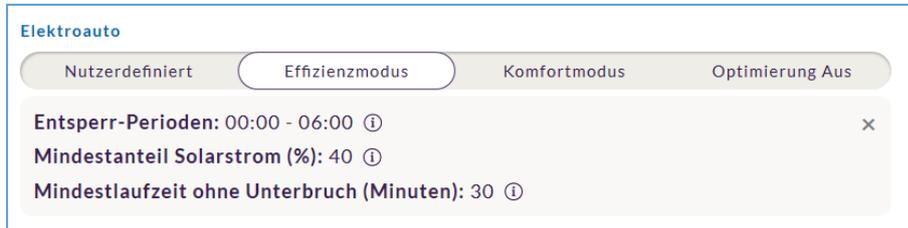
Abbildung 25: Effizienzmodus am Beispiel eines Elektroautos.
