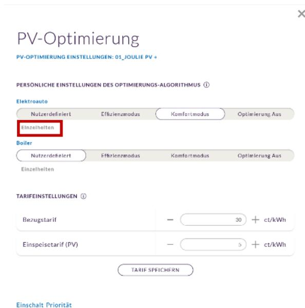
Abbildung 23: Die vier Grundeinstellungen der PV-Optimierung.
