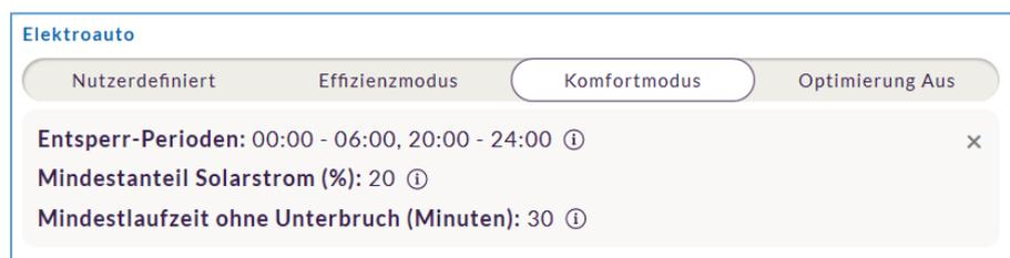
Abbildung 24: Komfortmodus am Beispiel eines Elektroautos.
