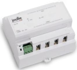
Abbildung 1: Bild einer K-Box der Marke tiko (Stromzähler und Steuerkontakt)
