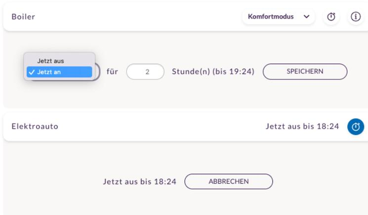
Abbildung 19: Screenshot des Web-Kundenportals mit Darstellung des Override-Modus während des Einstellvorgangs (Kessel, oben) und nach der Aktivierung (Elektroauto, unten)
